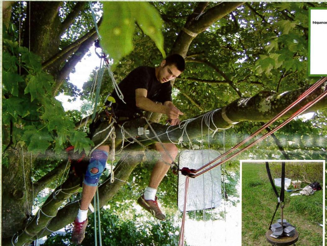
▲ Des capteurs de tension sont placés dans l'arbre pour mesurer l'amplitude d'oscillation que les branches peuvent supporter sans rompre.
