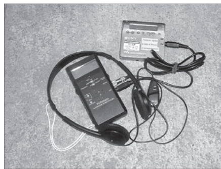
Le matériel de terrain : détecteur Pettersson D240x, mini disc Sony MZ R900 et casque d'écoute
