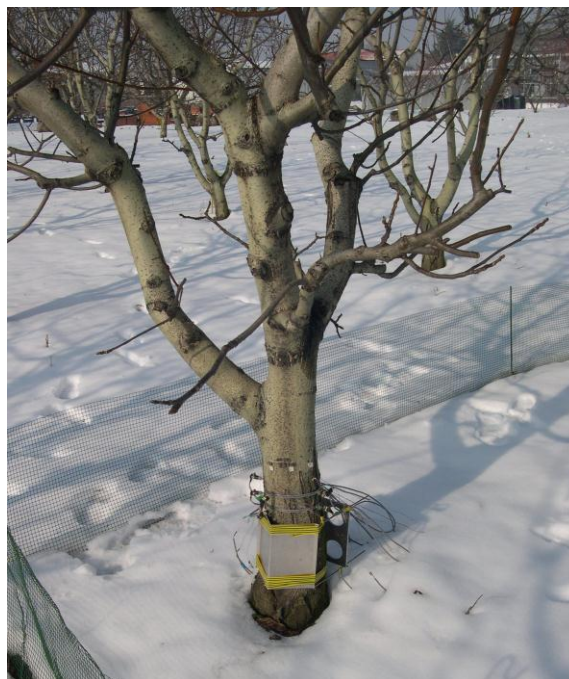
Suivi en continu de la température des différents organes d'un noyer au cours de l'hiver et détermination de la température de prise en glace (exotherme de congélation et variation de dimension du tronc)
