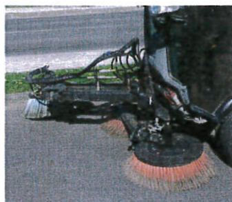
La balayeuse de voirie peut être utilisée sur des zones imperméables de grande longueur, en désherbage de fond préventif (stade plantule).
